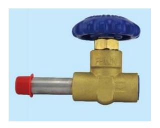
Криогенный запорный проходной сальниковый клапан серии DJ-10 выполнен из латуни и предназначен для перекрытия потока криогенной жидкости в трубопроводе. Наиболее часто используется в газификаторах малого объема и CO2 пеллетайзерах. Обезжирен для работы с кислородом.
